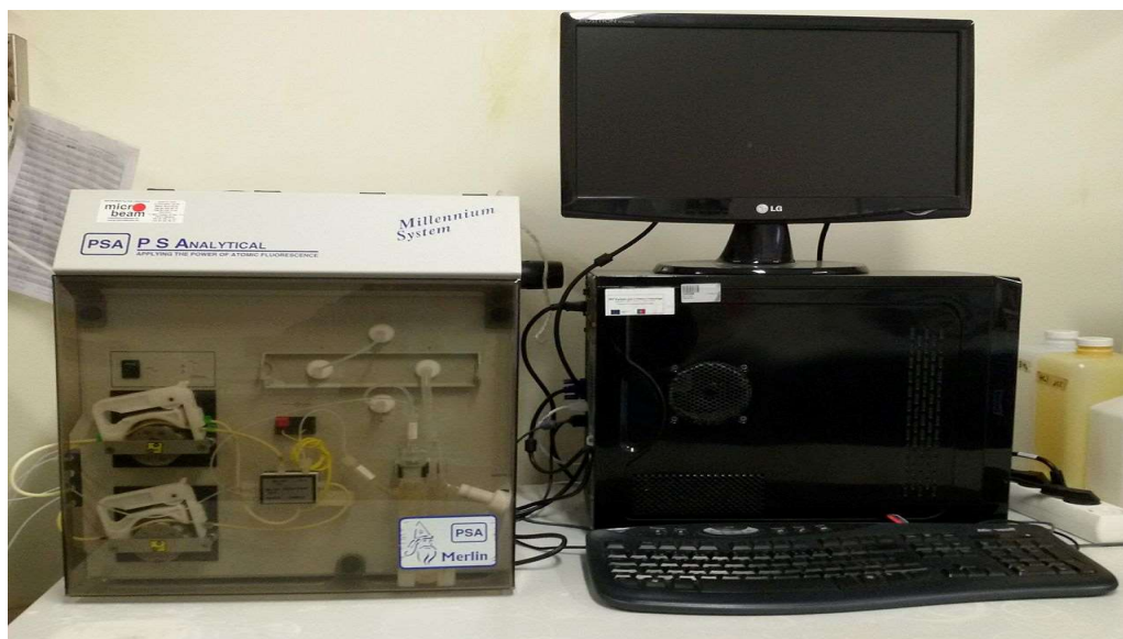
Figura 6 - Espectrofotômetro de fluorescência atômica utilizado na quantificação de mercúrio.
