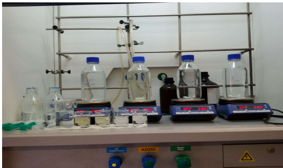
Figura 5 – Imagem da instalação experimental utilizada nos ensaios de remoção de mercúrio de soluções aquosas com AM-11 e AM-14.
