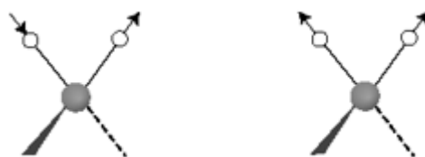
Figura 2 - Representação das vibrações de alongação, no lado esquerdo temos uma vibração antissimétrica e no lado direito temos uma vibração simétrica. Adaptado da referência [13].
