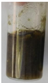
Figura 23 - Extração da cinaropicrina da folha do cardo com uma solução aquosa de 500 de mM de [C_{14}mim]Cl . Condições de extração: T=70^{\circ}C t=2h , R_{(S/L)}=1:10 .
