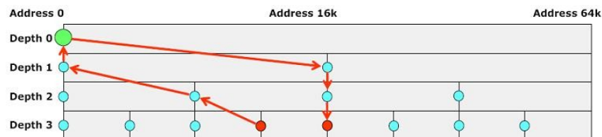
Figura 5.13: Protocolo de endereçamento baseado no algoritmo de cluster tree.
