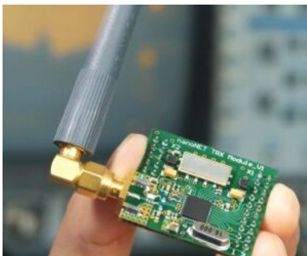
Figura 6.5: Exemplo tag RFID activa.
