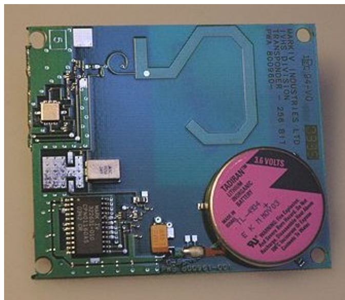
Figura 6.6: Exemplo tag semi-passiva.
