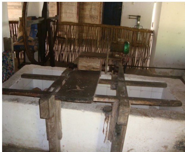
Figura 22 - Prensa de mandioca (Tipiti)
