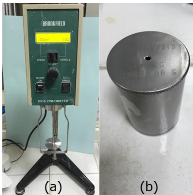
Figura 22: Viscosímetro de Brookfield (a) e picnómetro (b) utilizados para medir as características reológicas das barbotinas
