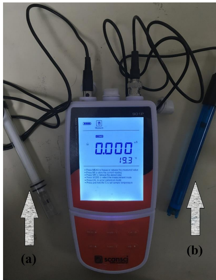
Figura 21: Medidor utilizado para ler os valores de pH (b) e condutividade (a)
