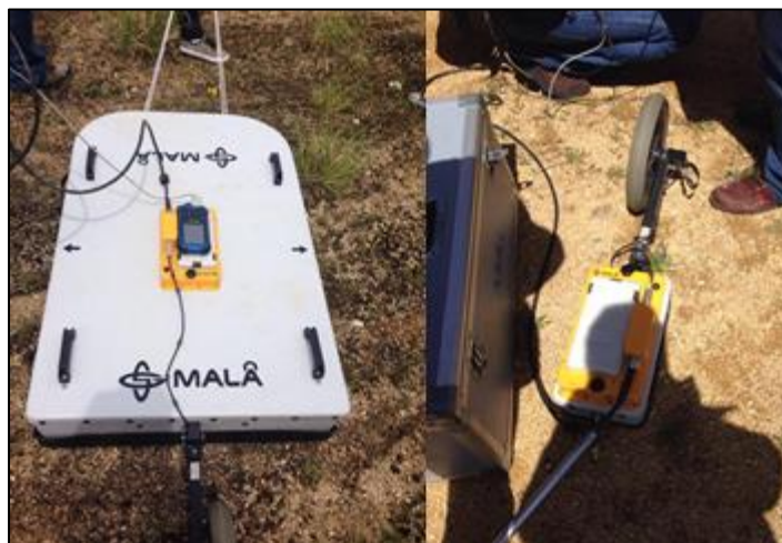
Figura 70: Antenas GPR 100MHz (à esquerda) e de 500MHz (à direita), utilizadas nos levantamentos de campo efetuados neste trabalho.
