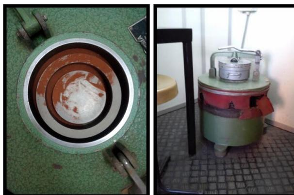
Figura 17 - Moinho mecânico de discos de aço com uma amostra de escombreira.
