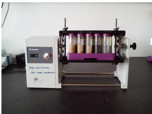
Figura 18 - Agitador dos tubos para a medição do pH.
