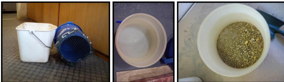
Figura 16 - Baldes de peneiração grosseira (à esquerda) e de peneiração a 2 mm (à direita).
