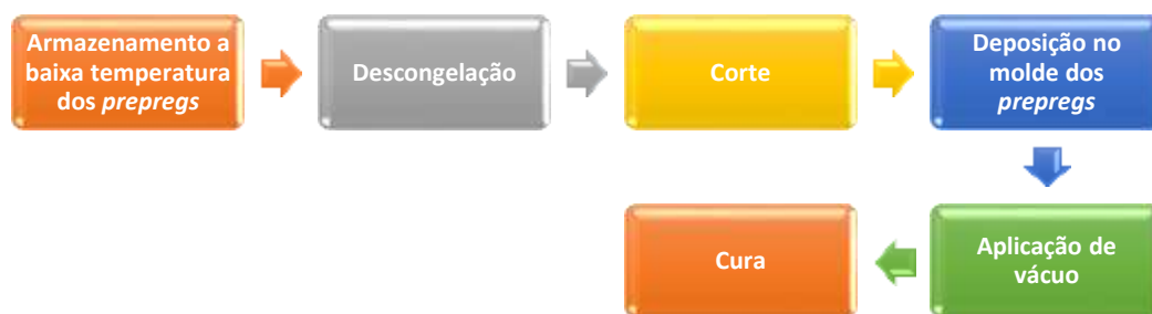
Figura 6: Processo produtivo quando é usada a técnica de prepregs .
