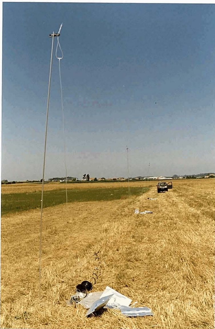
Figura IV.11 - Dispositivo de amostragem de SF 6 atmosférico.
