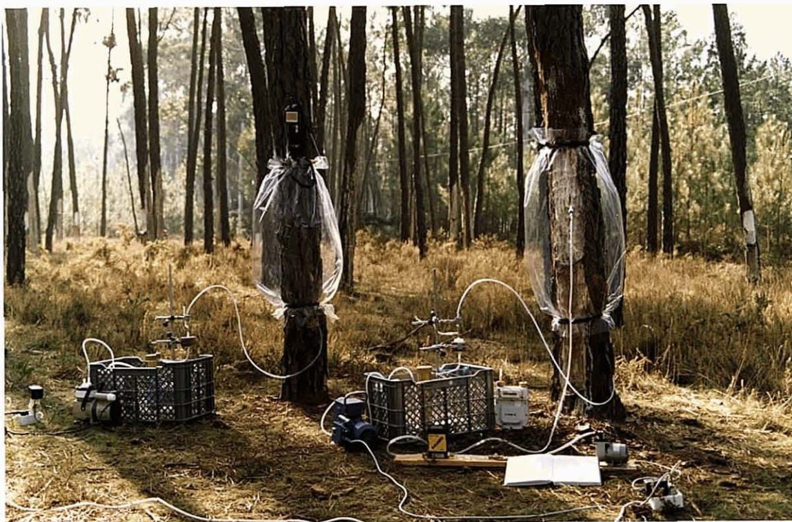
Figura IV.10 - Dispositivo de amostragem implementado nas campanhas de campo para a avaliação das emissões de terpenos resultantes da prática da resinagem.
