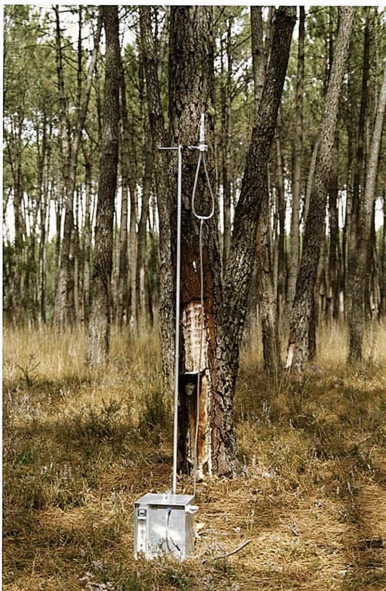
Figura IV.8 - Dispositivo de amostragem de terpenos atmosféricos.
