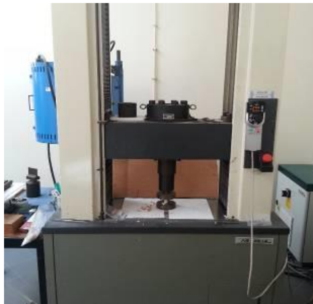
Figura 17 - Equipamento usado para realização dos Ensaio de Compressão Uniaxial
