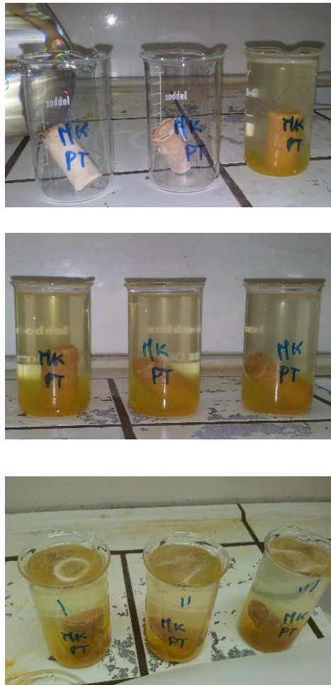
Figura 33 - Ataque ácido dos provetes de Metacaulino Português e Metacaulino Industrial, ambos com cura de 7 dias. Submersos em HCl 1:1. Reacção visível 2 minutos após a submersão. E após 4 dias de submersão
