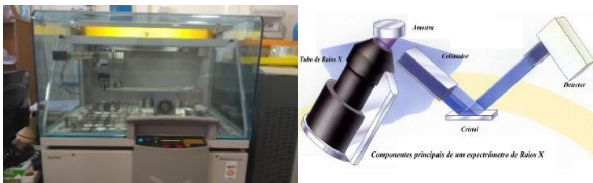
Figura 13 - Esquema de um espectrómetro de raios X.
