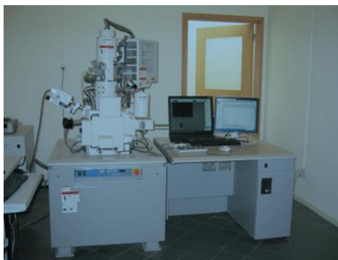
Figura 14 – Microscópio de Varrimento Electrónico, SEM - DEMaC
