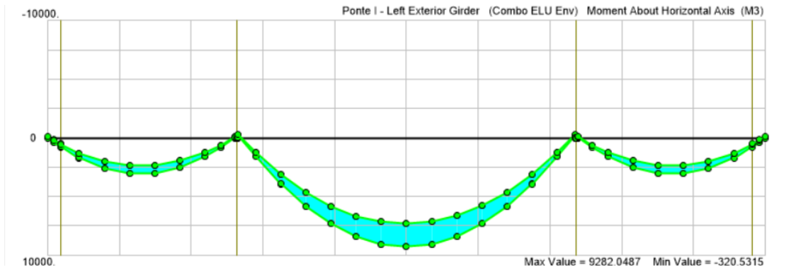
Figura 36 – Momento fletor atuante nas secções compostas longarina/laje do bordo esquerdo do tabuleiro.
