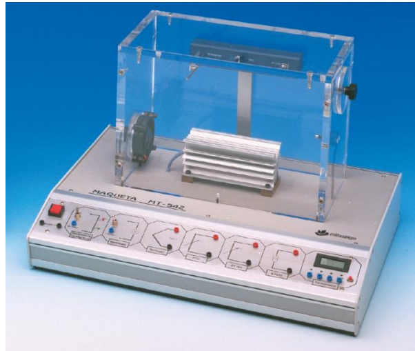
Figura 2.8 Equipamento didático "Study of temperature control processes" (Fonte: [4])
