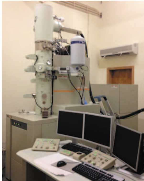
Figure 3.15: JEOL TEM microscope, used in thesis, Universidade de Aveiro.
