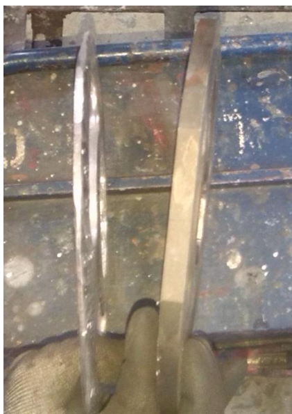
Figura 43 - Comparação entre um disco novo e um disco rejeitado.
