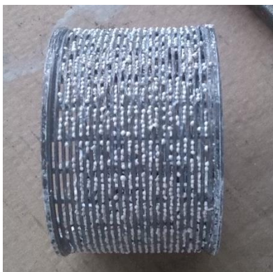
Figura 42 – Tamiz totalmente obstruído.
