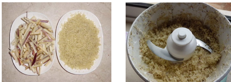
Figura 3.5 - Amostras de caules de cana-de-açúcar grosseiramente cortados e depois de triturados no moinho de facas (à esquerda). Moinho de facas (à direita).
