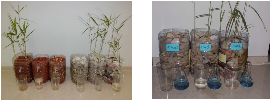
Figura 5.1 - Mini-ETAR de plantas. No período de adaptação das plantas (à esquerda) e as unidades com enchimento de calcário e conchas durante o período de monitorização da remoção de fósforo (à direita).
