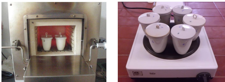
Figura 3.7 - Cadinhos com amostras calcinadas na mufla (à esquerda) e na placa de aquecimento durante o processo de solubilização com HCl (à direita).
