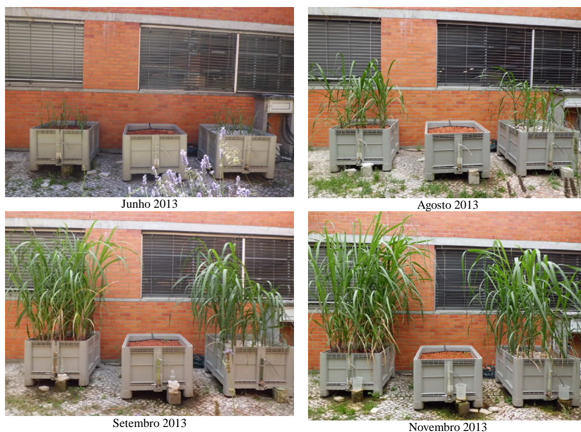
Figura 4.19 - Canas-de-açúcar em diferentes fases de desenvolvimento, plantadas nas unidades piloto com enchimentos de tijolo (tanque à esquerda) e de calcário (tanque à direita), em 2013.
