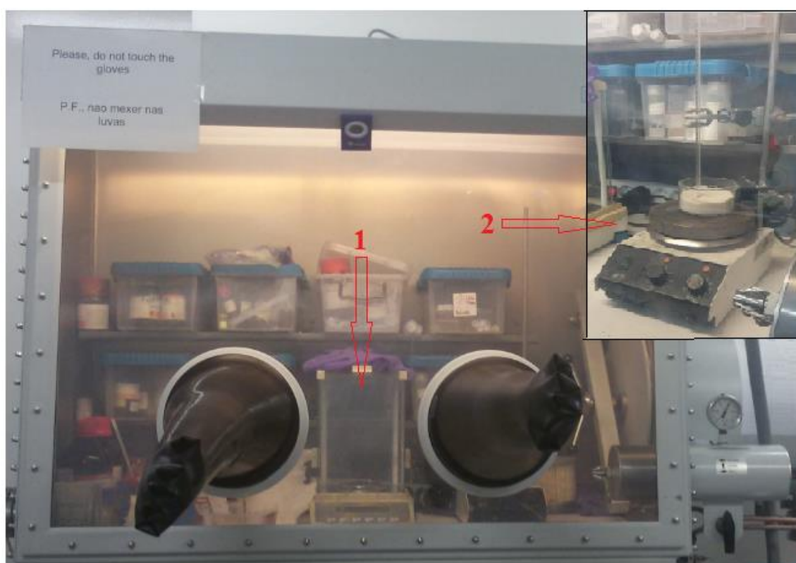
Figura 10. Caixa de luvas: 1 - Balança analítica; 2 - Agitador magnético.
