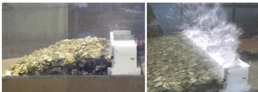
Figura 2.5: Exemplo de um modelo físico: observação dos galgamentos na solução proposta para a reparação do molhe Sul do Porto da Póvoa de Varzim (Reis e Neves, 2010).
