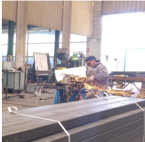
Figura 64 - Limpeza de solda.
