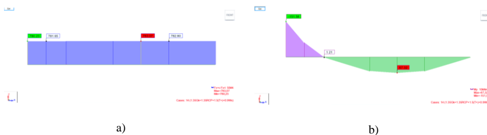
Figura 20 – a) Diagrama de Esforço Axial nas vigas a ligar; b) Diagrama de Momentos nas vigas a ligar.
