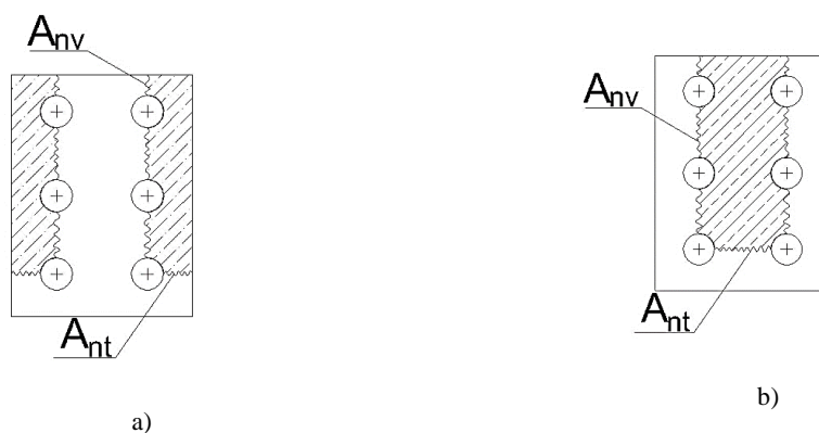
Figura 25 – a) Modo de rotura 1; b) Modo de rotura 2.
