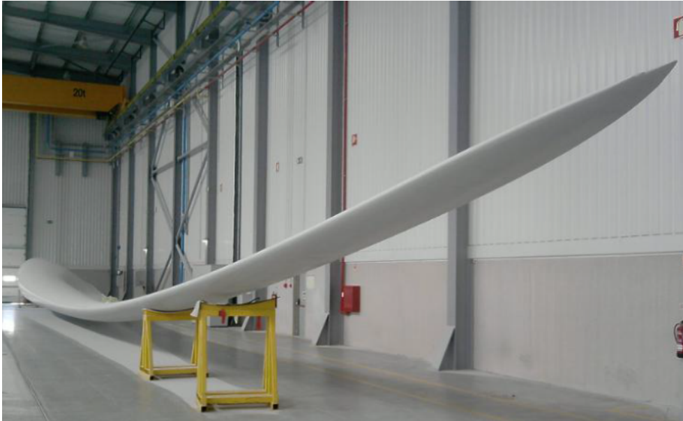
Figura 2.2: Pá eólica de 45,2 metros(RE45.2) (Ribeiro, 2012a).
