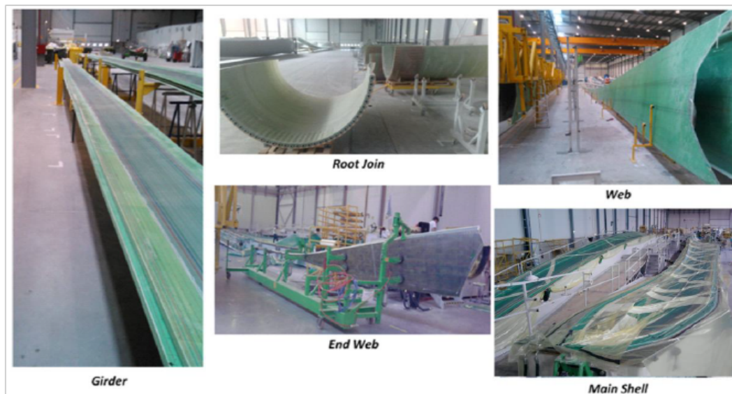
Figura 2.4: Elementos que constituem uma pá eólica (Ribeiro, 2012a).
