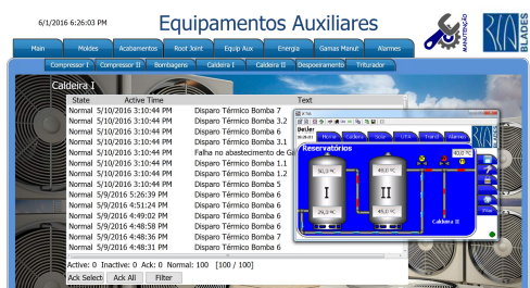
(a) Ecrã da estação de aquecimento de águas sanitárias.
