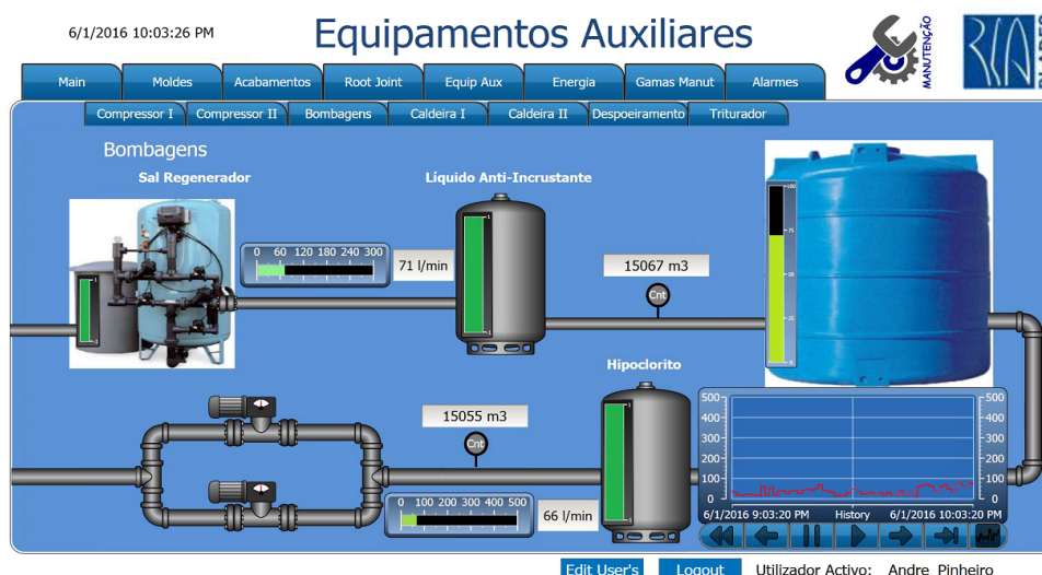
Figura 4.49: Ecrã da estação de bombagem de água.
