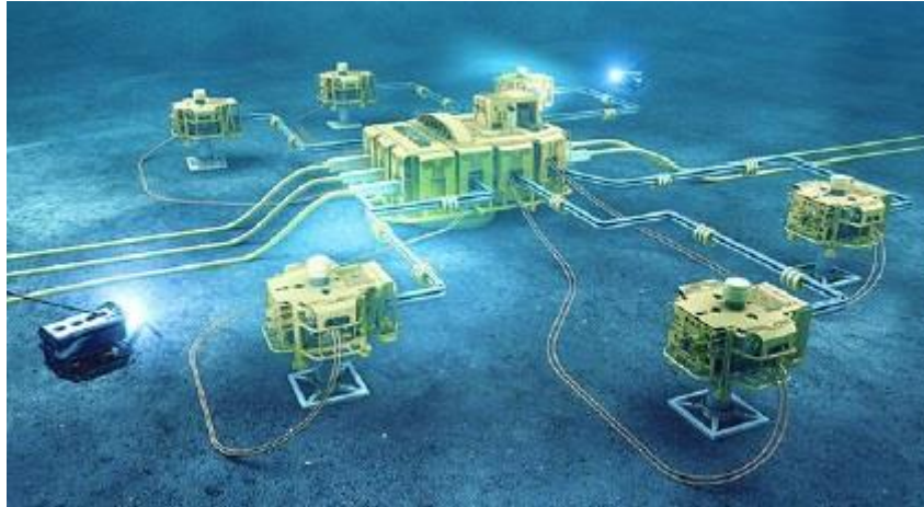
Figura 12-Manifold tipo Cluster ligado a 6 poços. Fonte: [40].
