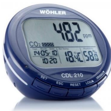
Figura 3.27 - Equipamento Datalogger Wohler CDL 210 utilizado
