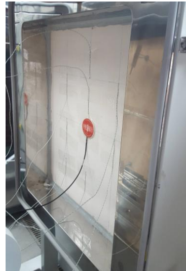
Figura 4.11 – Ilustração da distribuição do termofluxímetro na câmara climática 2 (exterior)
