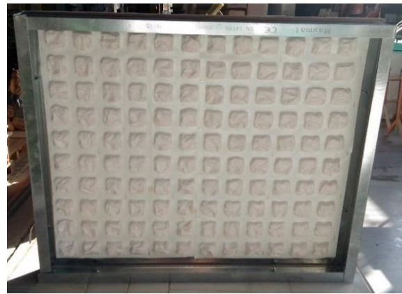
Figura 4.5 - Interior do provete com PCM
