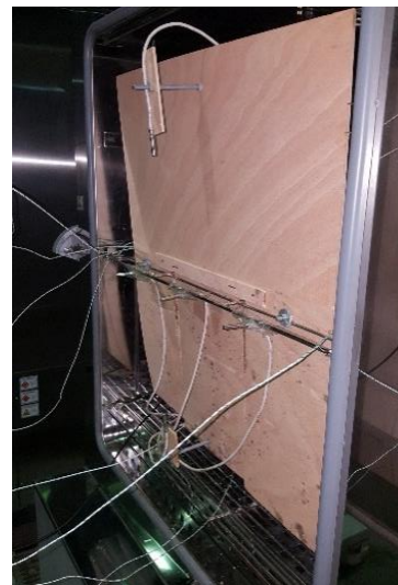
Figura 4.14 – Ilustração da distribuição das sondas de temperatura PT100 na câmara climática 2 (exterior)
