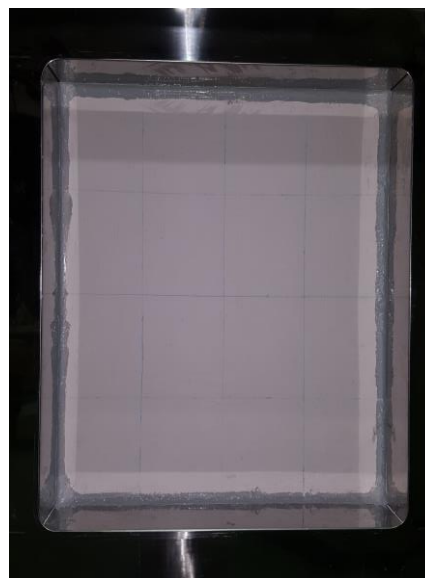
Figura 4.8 - Ilustração do provete de ensaio colocado no anel de ensaio
