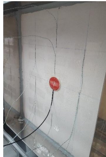
Figura 4.17 - Ilustração da distribuição sobre o provete dos termopares na câmara climática 2 (exterior)
