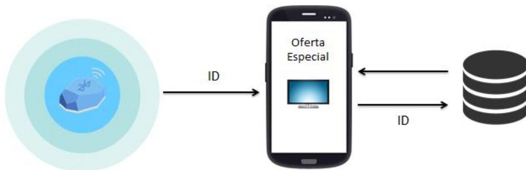
Figura 5 - Esquema de funcionamento dos beacons
