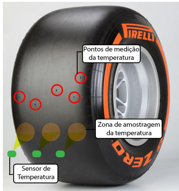
Figura 2. Modo de captura da temperatura no pneu.
