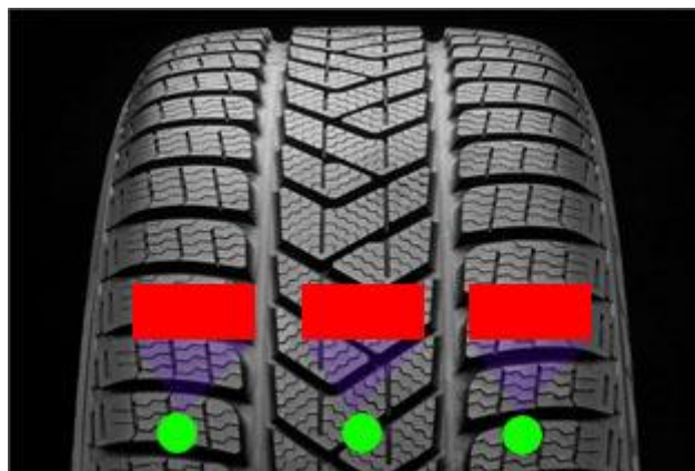
Figura 57. Representação do modo de leitura das temperaturas do pneu através do sensor Melexis MLX90614ESF-DCI.
