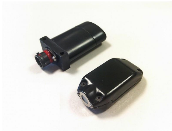
Figura 10. Sensores infravermelho wireless 8ch IR [16].
