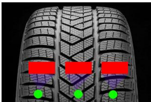
Figura 12. Esquema de leitura e posicionamento dos sensores sobre o pneu.
