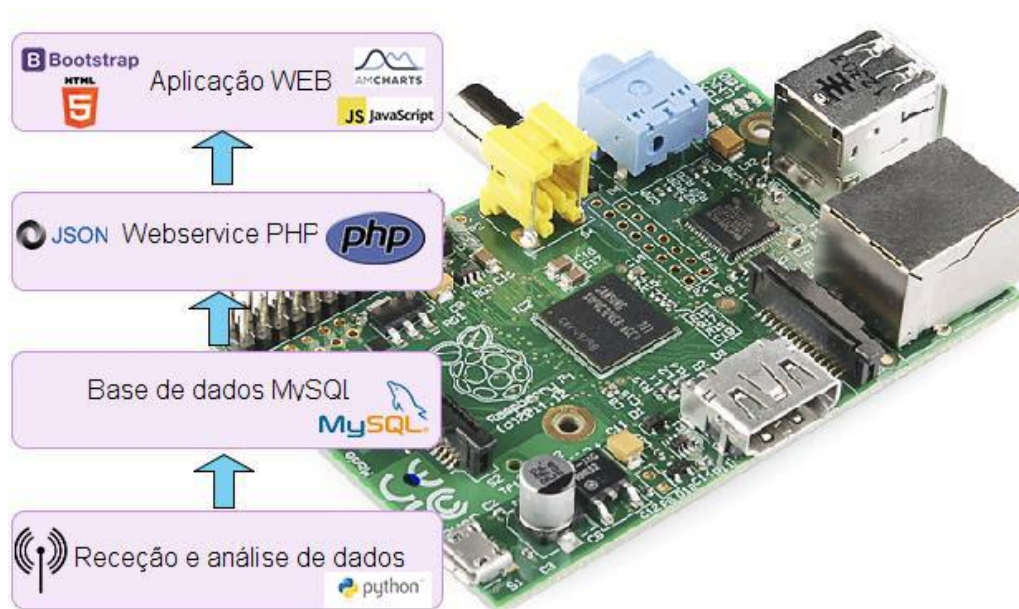
Figura 41. Diferentes camadas de Software presentes no Raspberry Pi.
