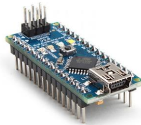
Figura 15. Arduino Nano ATmega 328 versão 3.0 [32].
