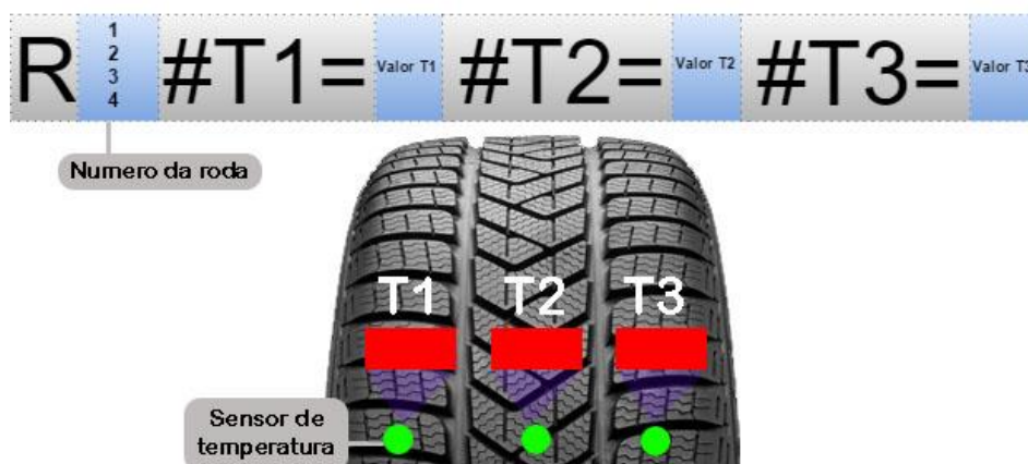
Figura 35. Formato da mensagem transmitida do Slave para o Master.
