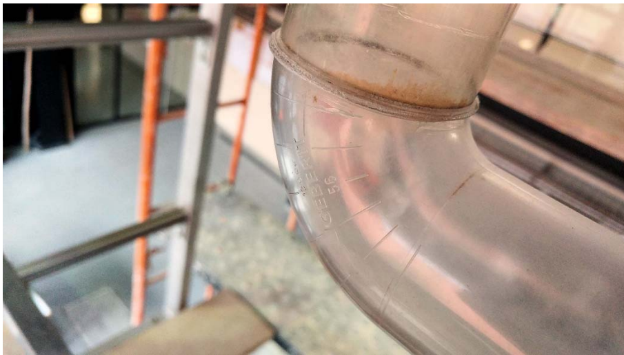
Figura 3.11: Tubagem de plástico transparente da instalação experimental.
