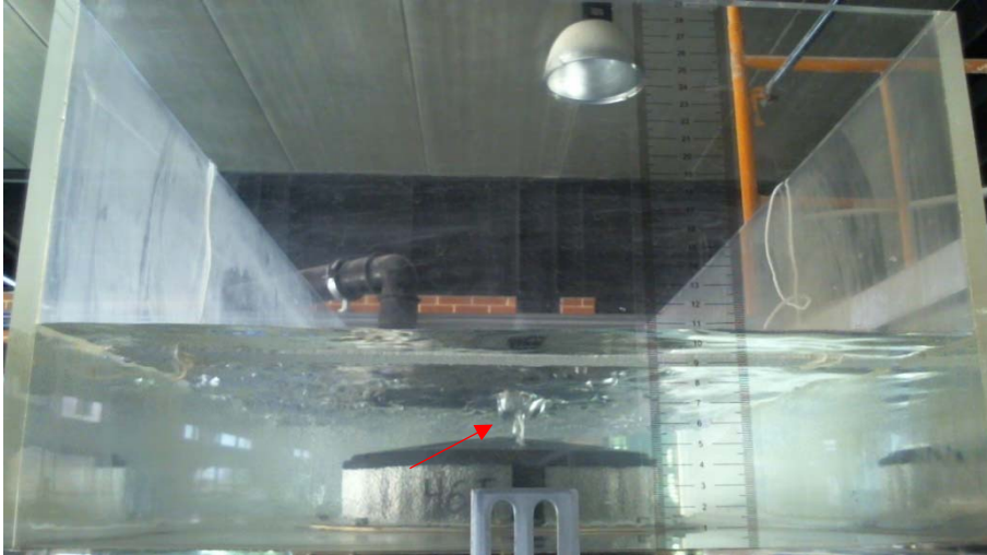
Figura 4.14: Vórtice visível no caudal 1,4 \times Q_0 com colmatação de 95% lateral.
