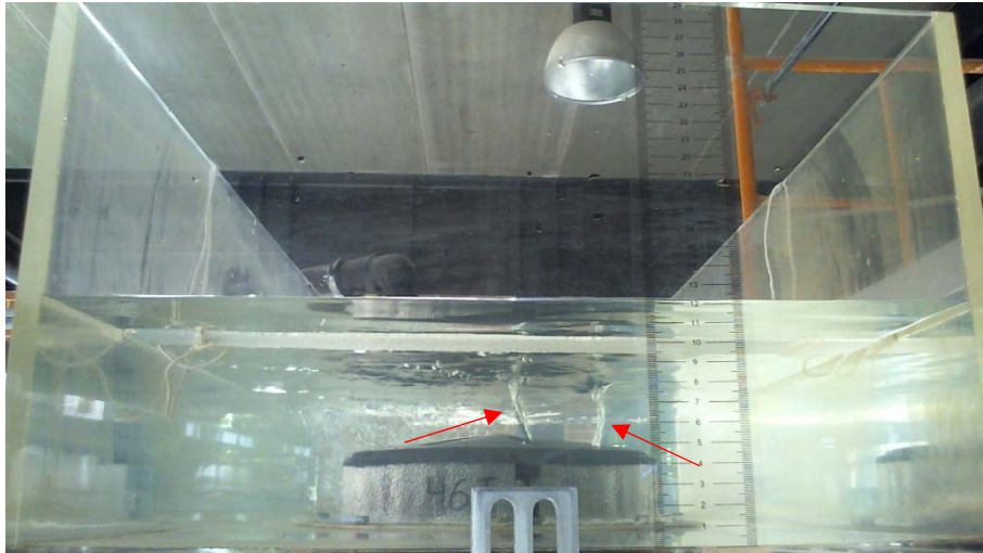
Figura 4.8: Vórtices visíveis no caudal Q_0 com colmatação de 95% lateral.
