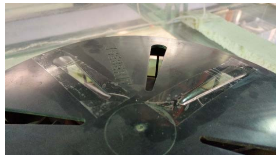
b) Pormenor da colmatação no topo, com aberturas colmatadas e não colmatadas
