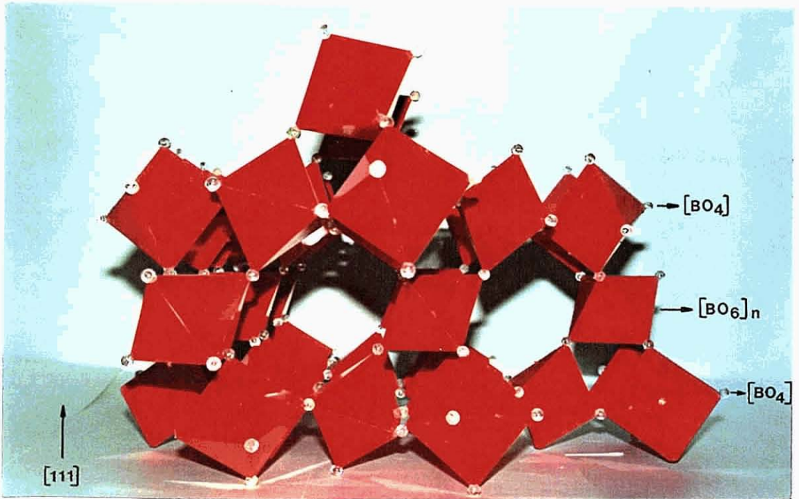
Figura 9a: Representação ideal de dois planos [BO_4]_n perpendiculares ao eixo [111] intercalados com o plano [BO_6] octaédrico de uma estrutura do tipo do pirocloro.
