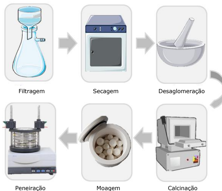
Figura 18: Etapas efectuadas após a síntese de pós. Os produtos das sínteses foram filtrados, secos e desaglomerados, para se proceder à sua calcinação a 800°C. Os pós obtidos foram moídos num moinho de bolas e peneirados, até se atingir o tamanho de partículas desejado.
