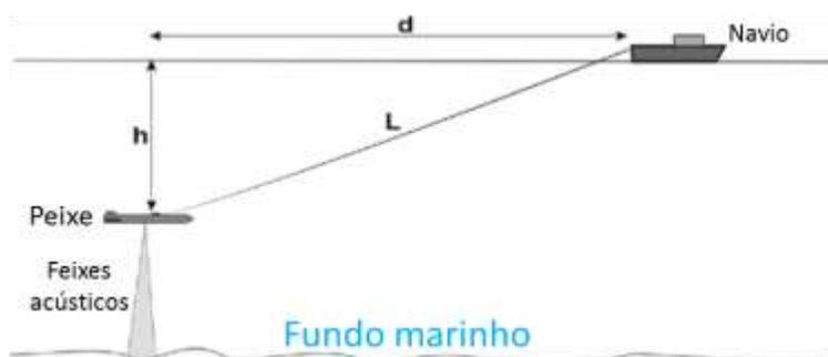
Figura 4.11. Representação do funcionamento de Sonar de Varrimento Lateral estando este a reboque do navio (adaptado de Henriques et al., 2012).
