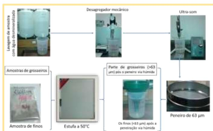
Figura 4.16. Peneiração via húmida.
