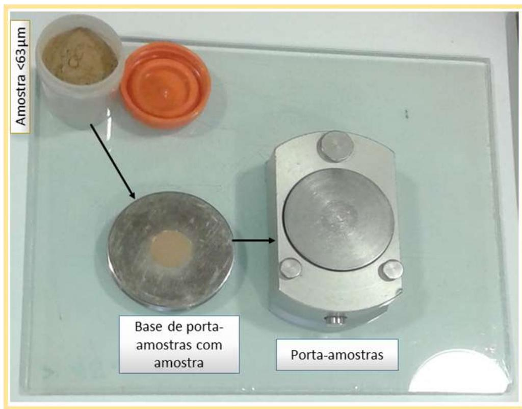
Figura 4.21. Visualização da fase de preparação de tomas de amostra para análise mineralógica
