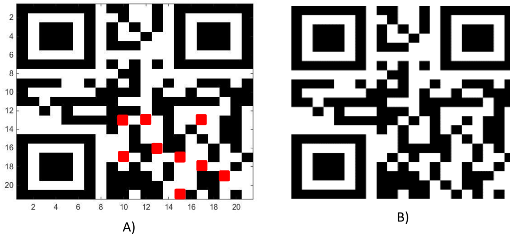
Figura 5.22 – A) Resultado da desmultiplexagem do código QR sobreposto e B) código QR original.
