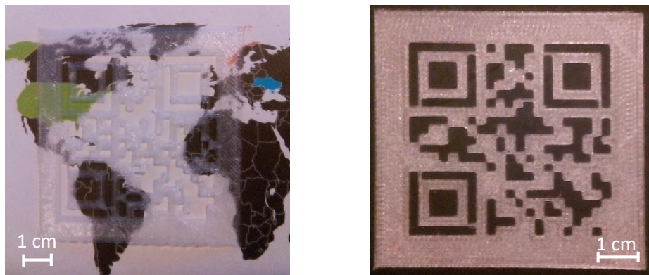
Figura 5.2 - Código QR impresso com uma impressora 3D sobre uma superfície preta e sobre uma superfície colorida.
