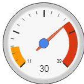
Figura 24 Gauge com alarmes de valor mínimo e valor máximo
