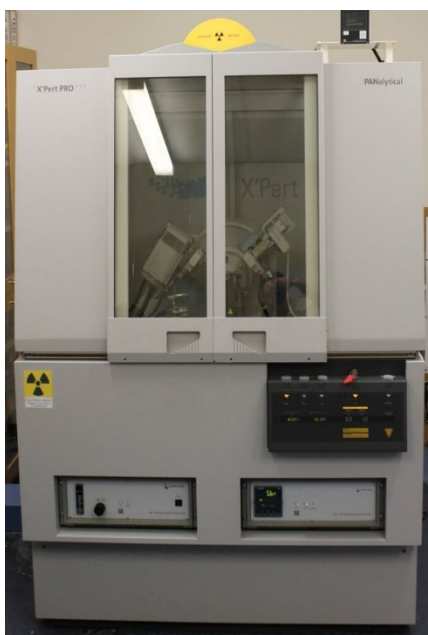
Figura 3.5 - Difractómetro PAN alytical XPERT PRO 3 , disponível no departamento de engenharia de materiais e cerâmica da universidade de Aveiro.
