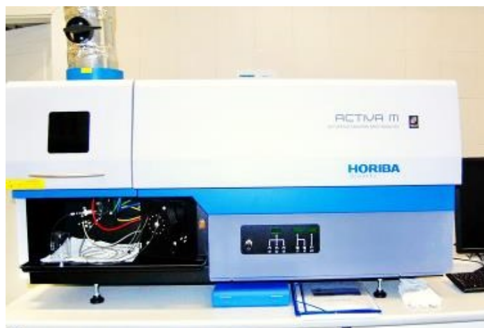
Figura 3.10 - Espectómetro HORIBA Jobin Yvon Activa-M [16].
