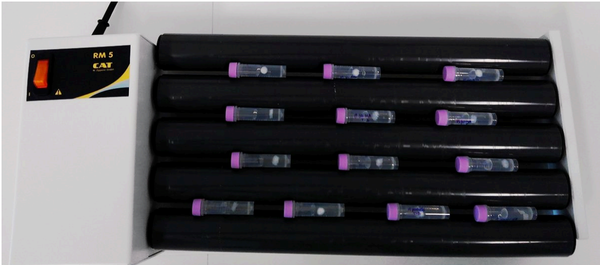
Figura 16- Membranas incubadas em agitação permanente num agitador de rolos (roller shaker).
