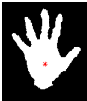
Figura 45. Determinação do centro da palma da mão fazendo o cálculo para todos os pontos.
