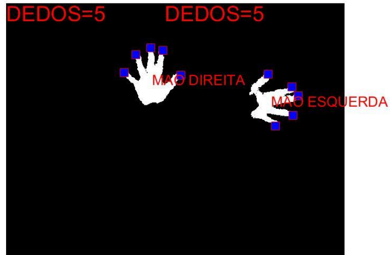
Figura 75. Frame processado de um fluxo de vídeo em profundidade adquirido da Kinect.
