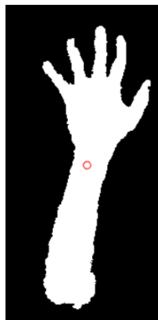
Figura 41. Imagem da mão com o antebraço obtida pela segmentação em profundidade, e representação da localização do centroide do objeto.
