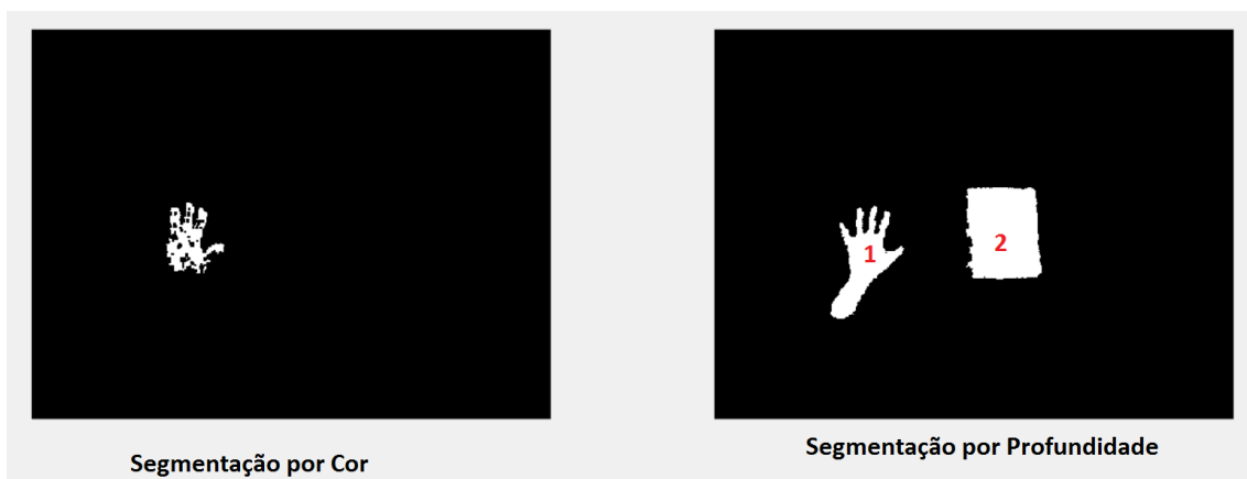
Figura 40. Representação do funcionamento da segmentação por cor da pele aliada à segmentação por profundidade.
