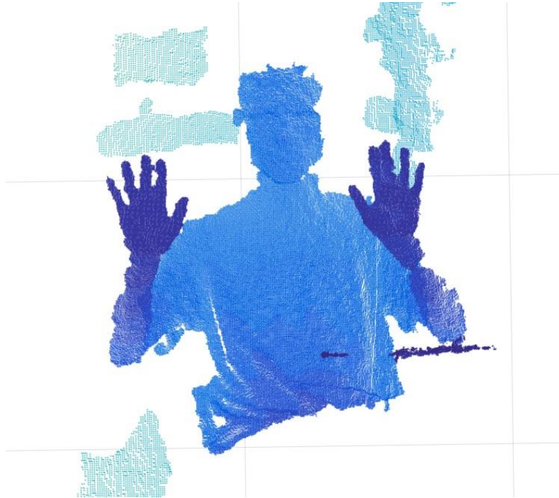
Figura 36. Nuvem de pontos obtida pela imagem em profundidade da Kinect dada pelo MATLAB.
