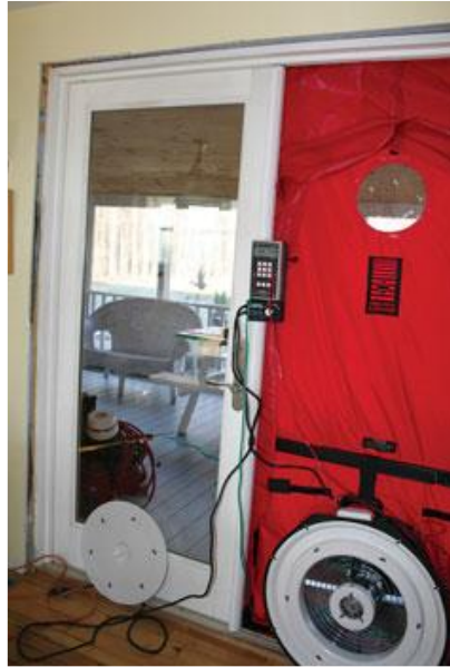
Figure 8 – Blower door test (Keefe, 2010).
