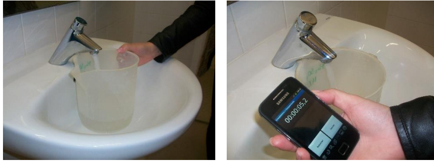
Figura 4.1 – a) Medição do volume através de um copo graduado; b) Medição do tempo de abertura das torneiras com o auxílio de um cronómetro.
