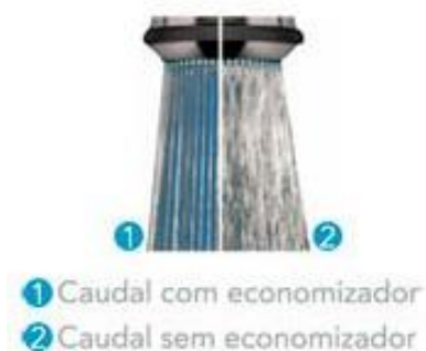
Figura 2.9 - Fluxo aparente do caudal com e sem economizador (SmartAqua, 2011).
