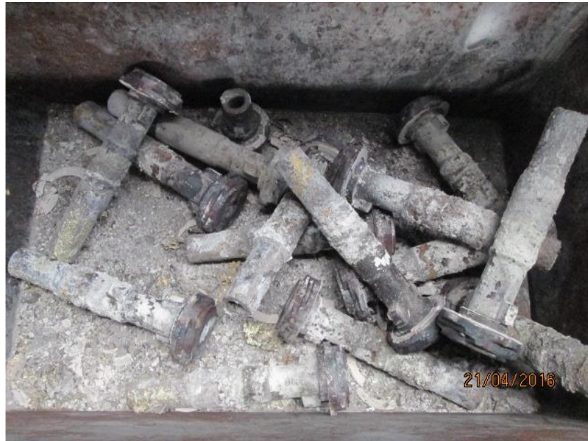
Fig. 26 - Used riser tubes.
