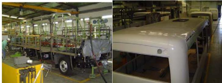
**Figura 19 - Elementos Estruturais do Autocarro e Fibras**
