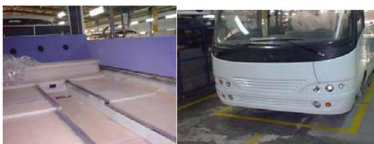
**Figura 21 - Revestimento de Soalho e Bagageiras e Colocação de Faróis**
