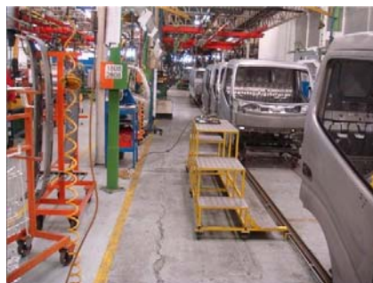
Fig. 16 - Vista parcial da linha do Bate-Chapas
