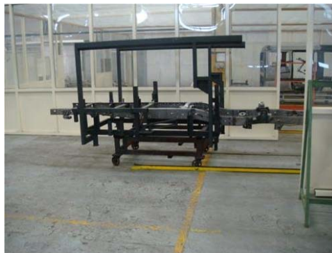
Fig. 17 - Chassi à saída da linha da rebitagem
