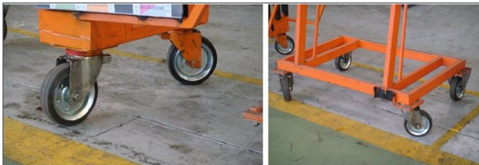
Fig. 44 - Transportadores com rodas de borracha
