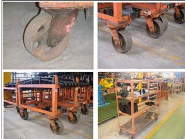
Fig. 43 - Exemplo de transportadores com rodas de metal
