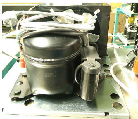
Figura 3.4: Compressor utilizado na bancada.
