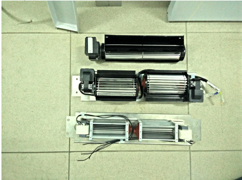
Figura 4.5: Fotografia das 3 opções de ventilação testadas.
