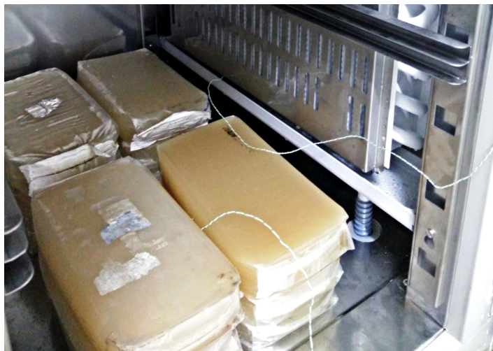
Figura 5.1: Disposição dos provetes no interior da bancada.
