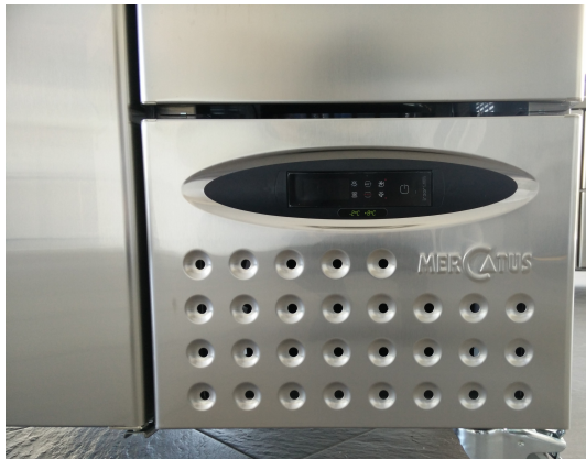
(a) Grelha de ventilação atual.
