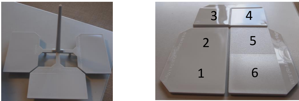
Figura 3.14 - A imagem da esquerda representa a peça injetada. A imagem da direita mostra as diferentes texturas aplicadas; 1 -VDI 20 ( R_a=1,00 \mu m ), 2 - VDI 10 ( R_a=0,32 \mu m ), 3 – Amostra polida 3 mm, 4 – Amostra polida 2 mm, 5 - VDI 40 ( R_a=10,0 \mu m ), 6 - VDI 30 ( R_a = 3,20 \mu m )
