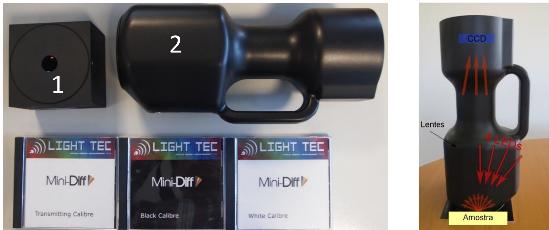
Figura 3.6 - Equipamento de medição de dispersão Mini-Diff. Do lado esquerdo: (1): Fonte de luz colimada (para medições em transmissão), composta por um LED de 622 nm e (2): Bloco óptico, composto por 4 LEDs (622 nm) em diferentes posições angulares e detetor CCD.
