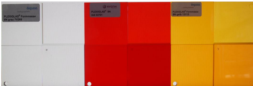
Figura 3.7 - Amostras de PMMA, de materiais utilizados em óticas de faróis.
