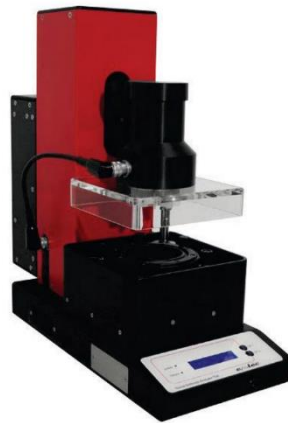
Figura 2.6 – Equipamento de determinação da maciez, TSA
