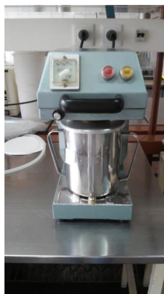
Figura 2.2 – Desintegrador utilizado para a preparação da suspensão de pasta
