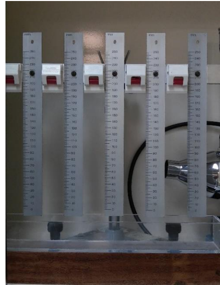
Figura 2.5 – Equipamento para a determinação da capilaridade klemm
