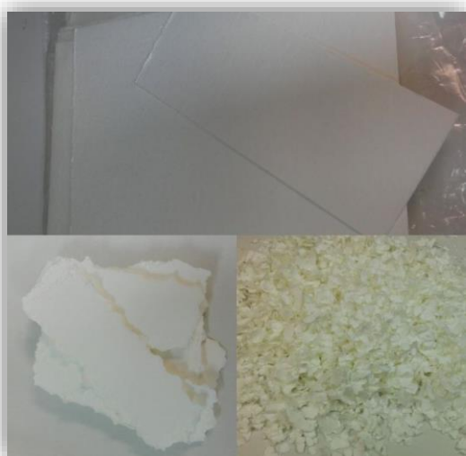
Figura 2.1 – Preparação da pasta para posterior desintegração
