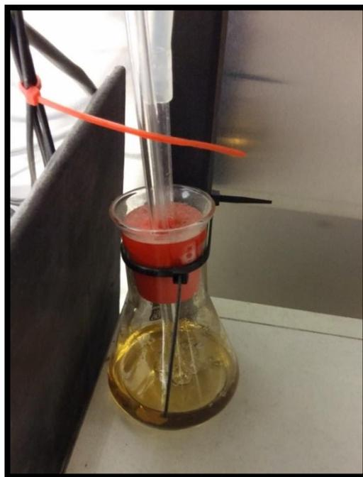
Figura 30 – Recipiente com óleo onde é libertado o gás proveniente da câmara do detetor que contém o MPGD THCOBRA.
