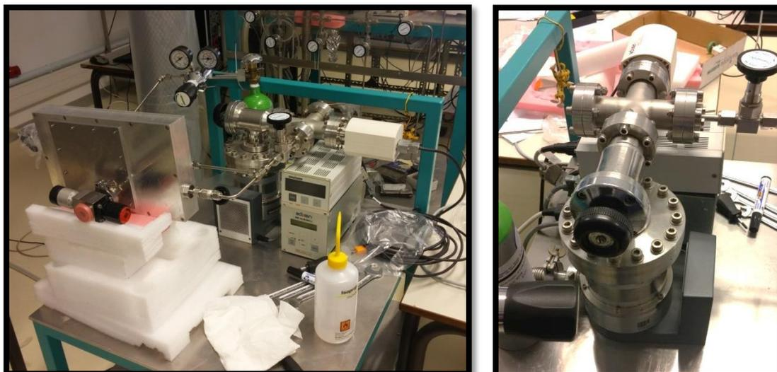
Figura 25 – Sistema de vácuo ligado à câmara do detetor (esquerda) e pormenor da bomba de vácuo usada (direita).
