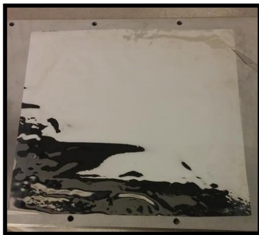
Figura 26 – Película de Mylar® colada na janela da câmara do detetor.
