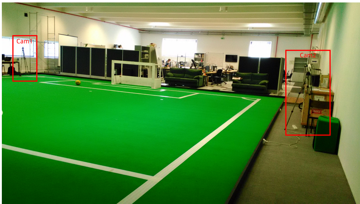
Figura 5.5: Fotografia da configuração das câmaras utilizada para efetuar o estudo do impacto que a calibração dos parâmetros intrínsecos tem na obtenção das coordenadas 3-D da bola.
