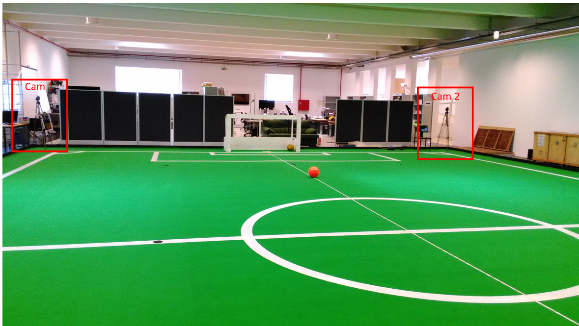
Figura 5.9: Fotografia da configuração das câmaras utilizada para efetuar o estudo do impacto que a distância da bola às câmaras tem na obtenção das suas coordenadas 3-D.
