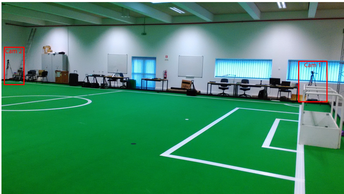
Figura 5.11: Fotografia do posicionamento das câmaras utilizada para a realização do teste geral, que visa efetuar uma avaliação global do sistema no que diz respeito à precisão da obtenção das coordenadas 3-D da bola.
