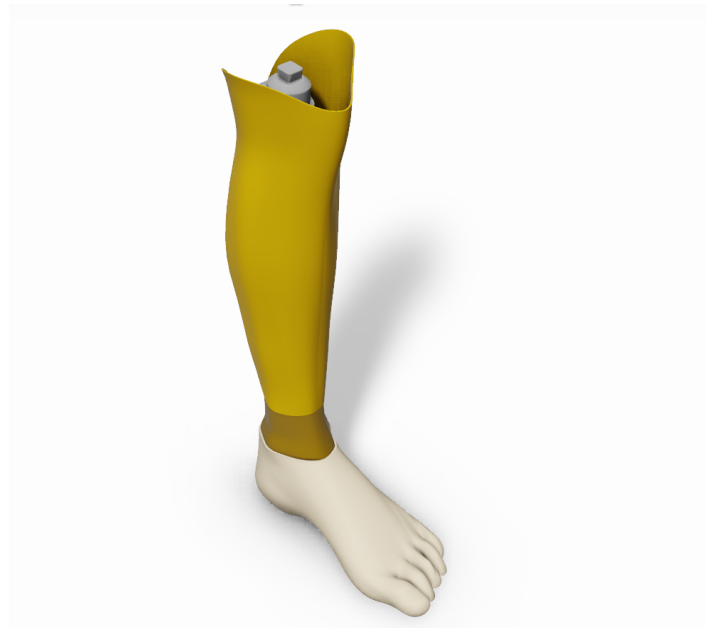
Figura 4.13: Modelo tridimensional do conjunto dos componentes protéticos (joelho, haste, pé e cobertura estética).
