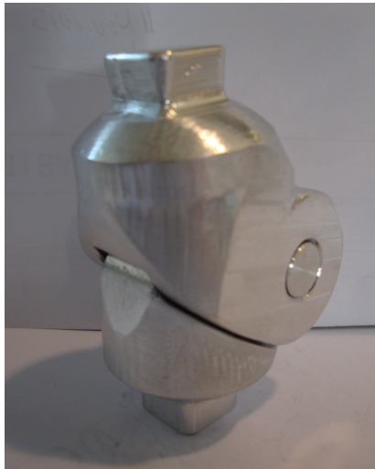
Figura 5.6: Joelho protético de eixo-único desenvolvido.
