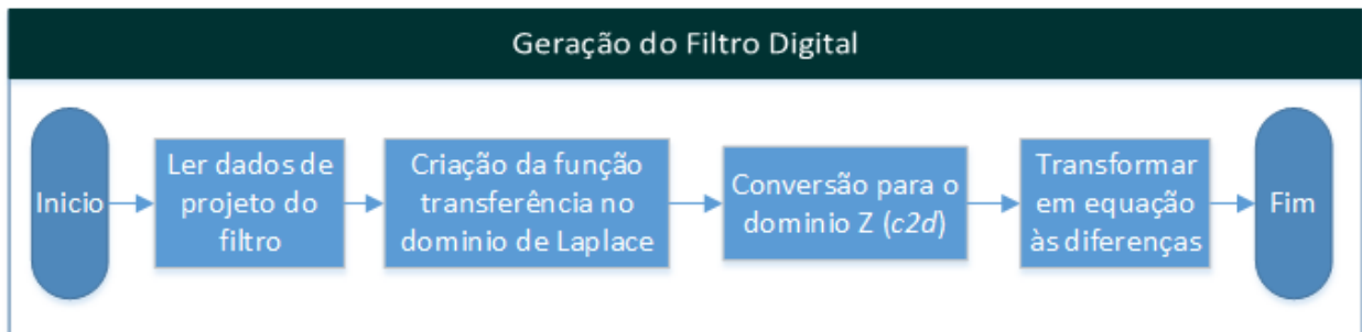
Figura 6-7 - Fluxograma do algoritmo de Criação do Filtro Digital
