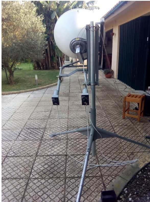
Figura 2-11 - Sistema de apontamento com antena (parte mecânica)
