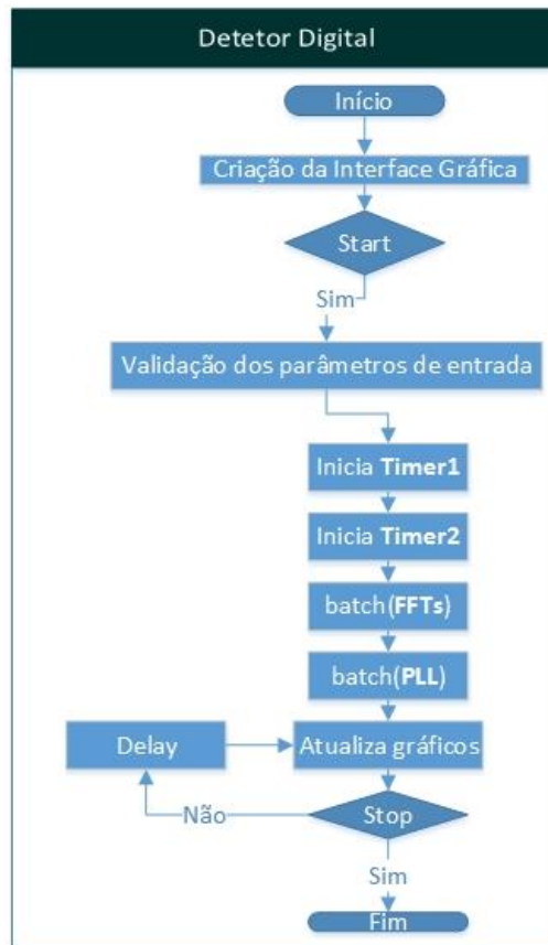
Figura 6-16 - Fluxograma do algoritmo do Detetor Digital
