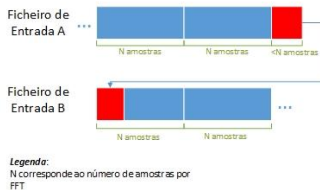
Figura 6-2 - Concatenação de amostras não processadas
