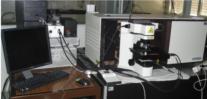
Figura 3.5: Equipamento utilizado na aquisição dos espectros de Raman.
