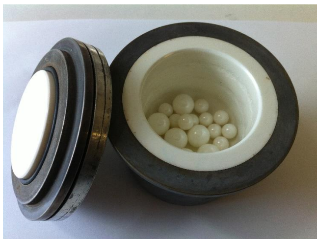
Figura 4.1: Cuba onde é realizada a mecanossíntese e bolas de Zircónio com dois tipos de diâmetros.
