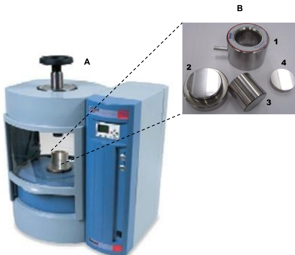
Figura 11 - Equipamento usado na preparação das amostras para análise no espectrómetro de XRF. A - prensa Hidráulica Atlas™ Power Specac, 25 t; B - Conjunto metálico; 1 - Cilindro; 2 - Base do cilindro; 3 - Pistão; 4 - Disco metálico
