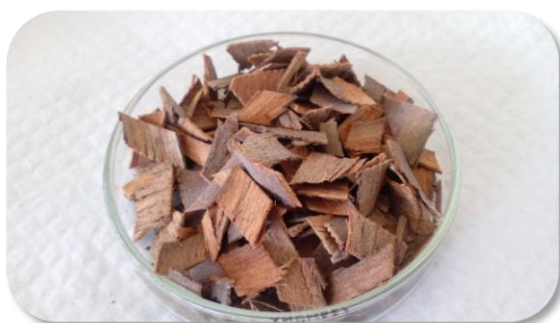
Figura 16 - Amostra de casca de eucalipto após redução de tamanho recorrendo a tesoura de poda
