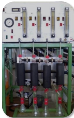
Figura 20 - Unidade de medida da fase gasosa da instalação e condensadores
