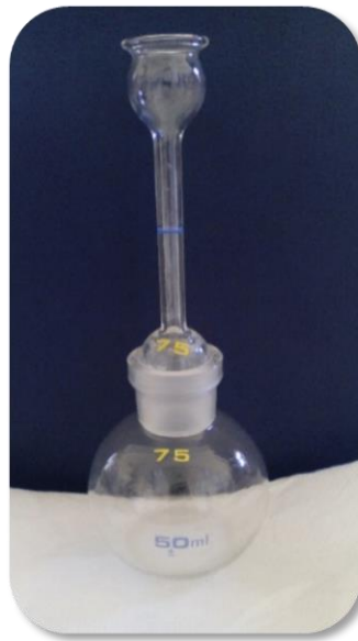
Figura 23 - Picnómetro de sólidos, utilizado na determinação da densidade real
