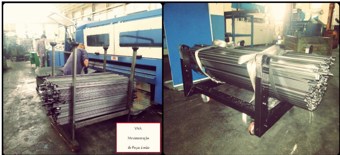
Figura 17 - Recolha de peças (método antigo – à esquerda - e método atual – à direita)
