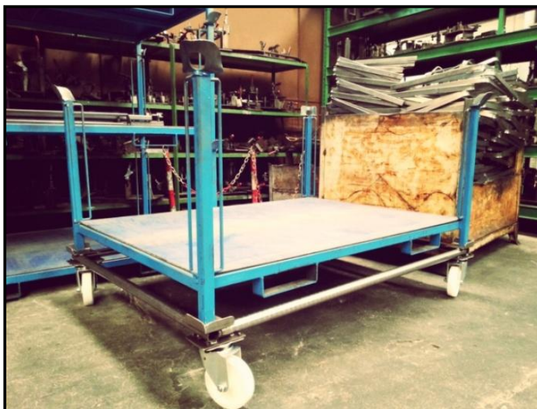
Figura 32 - Contentores da zona da soldadura, com o novo suporte (parte inferior da figura)
