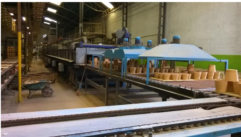
Figura 9. Forno de rolos – saída das peças cerâmicas após cozedura.
