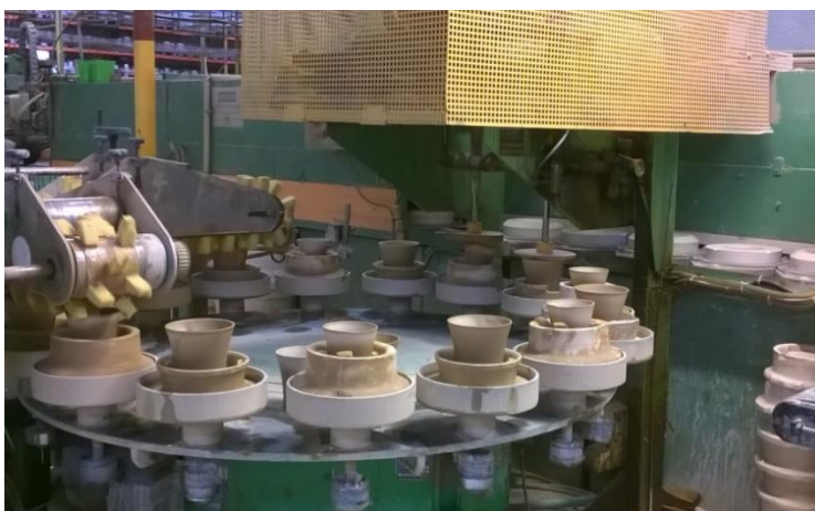
Figura 7. Sector da Conformação – vista do acabador da Roller I, após saída dos vasos crus da pré-secagem.
