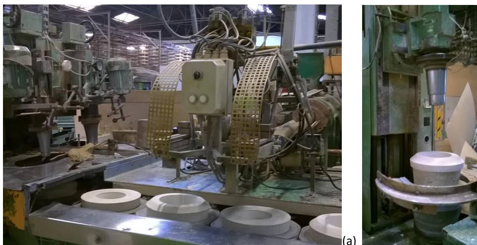
Figura 6. Sector da Conformação – (a) pormenor da linha de produção da Roller I; (b) pormenor da cabeça e da panela da Roller VII.
