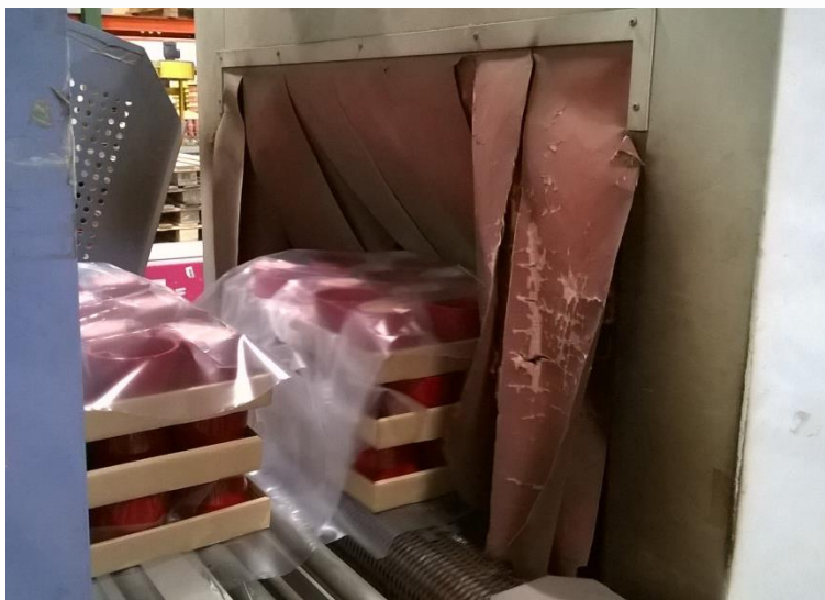
Figura 11. Sector da Embalagem – pormenor da entrada da câmara de encolhimento
