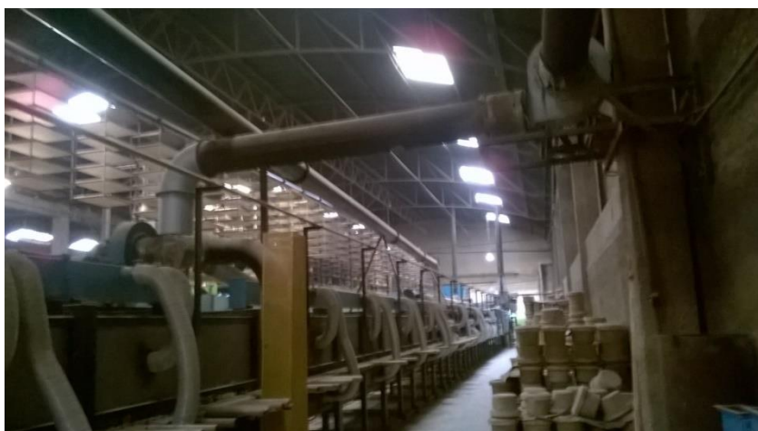
Figura 8. Secador horizontal de rolos (zona da estufa do forno), com vista das condutas de recuperação de calor da zona de arrefecimento.
